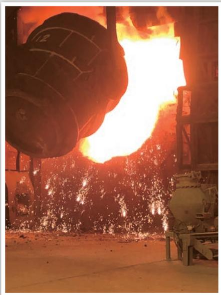
轉爐煉鋼巨大的盛銑桶將熔銑倒入轉爐中，耀眼的火光與飛濺的火花交織，瞬間溫度可高達數千度以上。照片中洶湧噴濺的鐵水不僅象徵著煉鋼過程的劇烈，更映射出煉鋼工人辛勤付出的每一滴汗水與每一次堅守崗位的堅韌。
